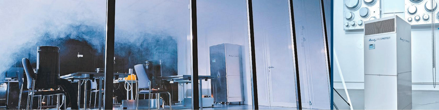
Ausbreitung der Reinluftwalze im Versuchsaufbau
